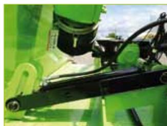
Transportverriegelung der Flügel-Elemente
