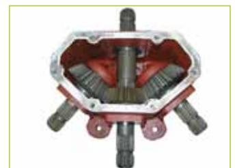
massives 260 PS Verteiler-Getriebe mit 1-3/4" starken, verzahnten Getriebe-Wellen
