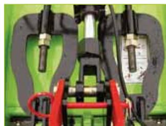
Parallel-Führungsgestänge zur Einstellung der Deckneigung
