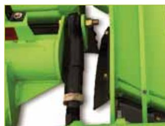
abschmierbare, justierbare Gewinde-Spindeln für Parallel-Höhenverstellung
