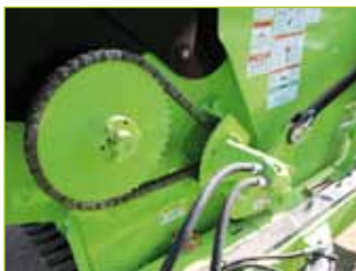
Haspel-Antrieb über Kette und Hydraulik-Motor
